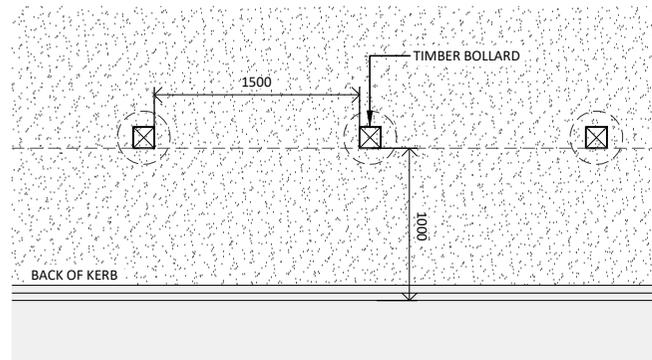
02 FRANGIBLE TIMBER BOLLARD ALONG EDGE OF ROAD - PLAN
